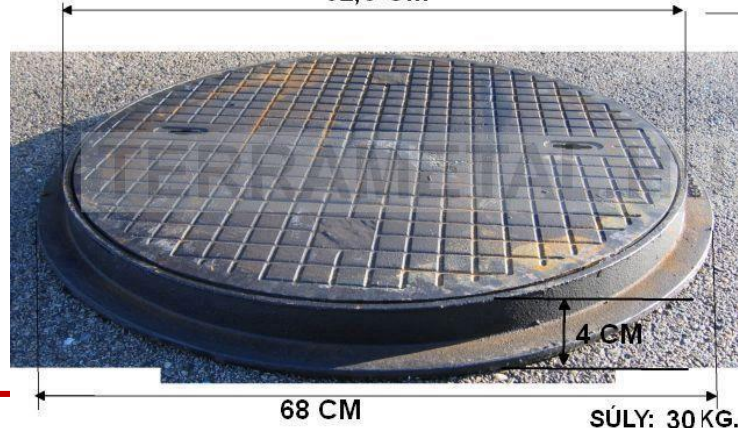
600-AS KÖR ALAKÚ ÖNTÖTTVAS AKNAFEDLAP KERETTEL GYALOGOS ZÖLDTERÜLETI BEÉPÍTÉSRE 62,5 CM
