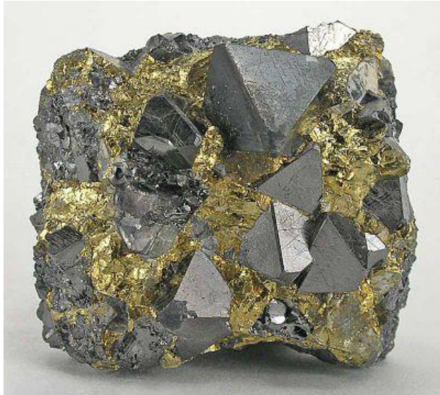
Magnetit (mágnésvasérc) \text{Fe}_3\text{O}_4 , vastartalom: 50...70%
