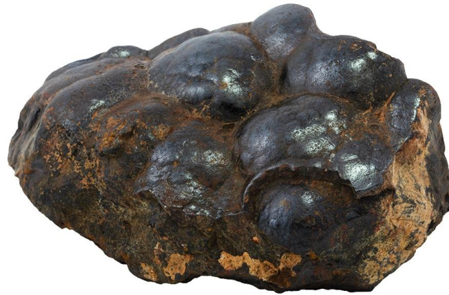
Hematit (vörösvasérc) \text{Fe}_2\text{O}_3 , vastartalom: 40...60%
